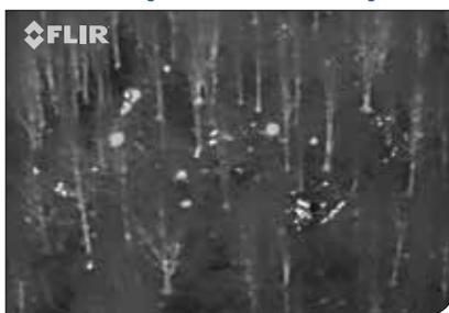
Optimieren Sie Nachlöscharbeiten durch Identifizierung von unterirdischen Brandherden.
