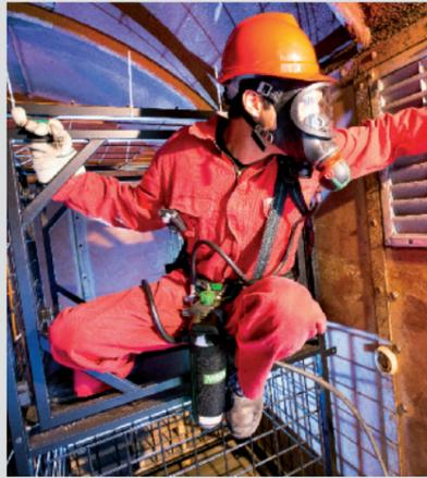
Die **PremAire Combination**, eine vielseitige, komfortable und erschwingliche Schlauchfluchtgeräte Kombination mit Druckluftflasche. Die schlanke Konstruktion integriert die erste Druckmindererstufe und das Flaschenventil in einer Baugruppe, wodurch Größe und überstehende Teile stark reduziert werden, und damit auch die Gefahr des Hängenbleibens beim Arbeiten in engen Räumen.
