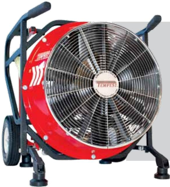
Die Hochdruck-Hochleistungslüfter (HP) haben das Vent4MAX-Frontgitter und einen speziellen Luftleitmantel für einen verdichteten Luftstrahl. Durch diesen "Vollstrahl" wird ein höherer Druckaufbau im Gebäude erreicht und die höhere Strömungsgeschwindigkeit erlaubt den Hochleistungslüfter in größerer Entfernung vor der Eingangstür zu platzieren.
